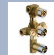
PD 738 Misc. termostatico doccia parte incasso da 3/4" con deviatore 2 uscite e arresto incorporato da 1/2" e rubinetto da 3/4" Thermostatic bath/shower concealed body with 2 outlets diverter, 1/2" built-in stop and 3/4" cock
